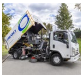
Минимальный угол выгрузки 48°
